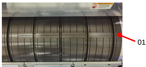
图5-6 版材边缘检测 U 槽
